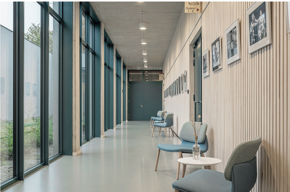
De houten lambrisering zorgt voor een aangename ruimteakoestiek, de patio geeft licht en lucht aan de circulatie.
